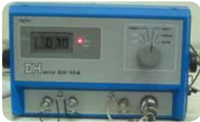
Oben: Polarographisches DH Messgerät („dissolved“ hydrogen) von TOA-DKK, das auch zur Erforschung von elektrolysiertem Wasser zertifiziert ist.
